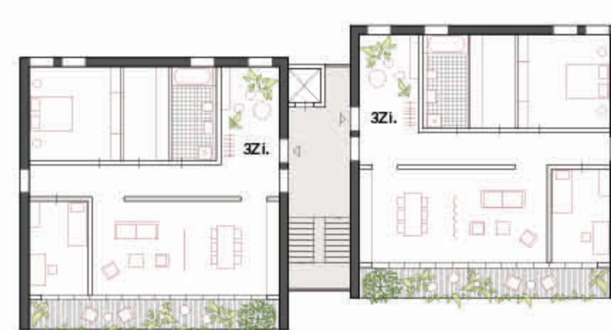
Grundriss 2. Obergeschoss, Wohnungen Teil West M 1:250
