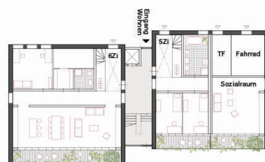
Grundriss Erdgeschoss, Wohnungen Teil West M 1:250
